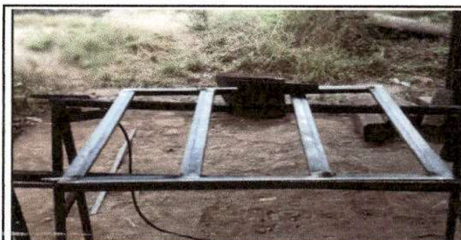
Foto 6: Realización de fabricación e instalación de ventana - balcon de metal.
